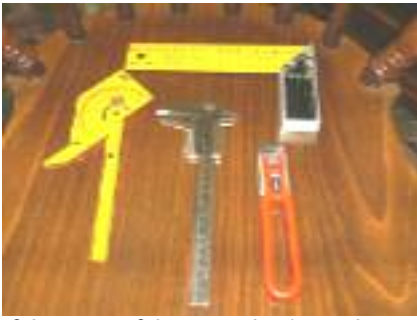
Squadra da falegname, falsa squadra (per misurare gli angoli) calibro e taglierino.
