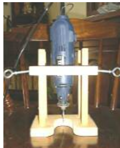
Questo è il porta micromotore AUTOCOSTRUITO
