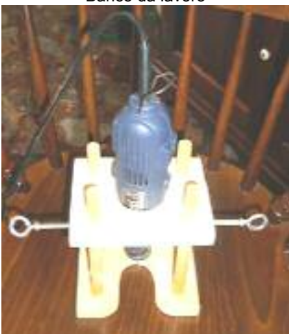
Questo è il porta micromotore AUTOCOSTRUITO
